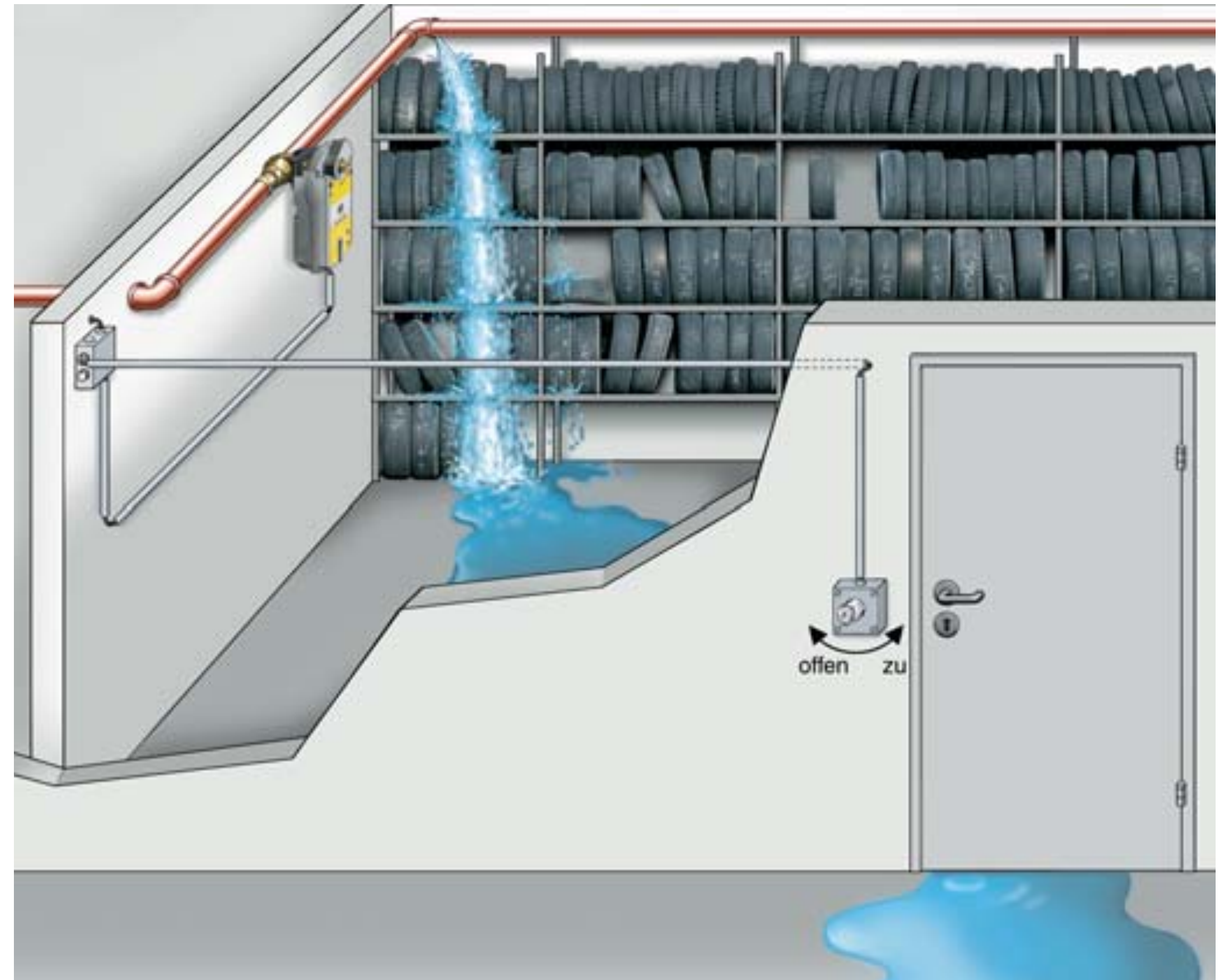
Відключення KHS-VAV-plus в приміщенні із замкненими дверима за допомогою клавішного вимикача.
