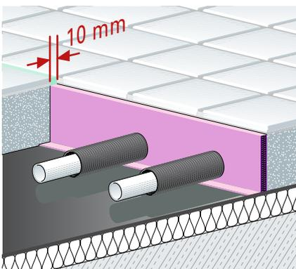
Для выполнения деформационного шва между поверхностями пола ФРЭНКИШЕ предлагает специальную демпферную ленту profitherm и защитные кожухи profitherm для труб.
