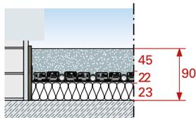
Тип 2  $R \geq 1,25 \text{ м}^2 \text{ К/Вт}$  – Полы комнат, лежащих над неотапливаемыми/частично отопляемыми помещениями или грунтом
