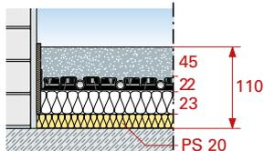
Тип 3  $R \geq 2,00 \text{ м}^2 \text{ К/Вт}$  – Полы комнат, лежащих над помещениями с температурой наружного воздуха ( $-5^\circ\text{C} > T_d > -15^\circ\text{C}$ )
