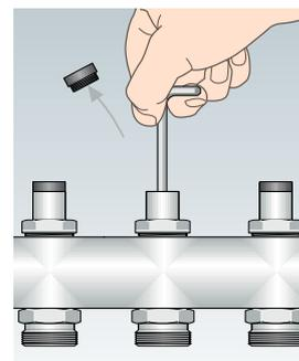
Регулирующий вентиль со шпинделем
