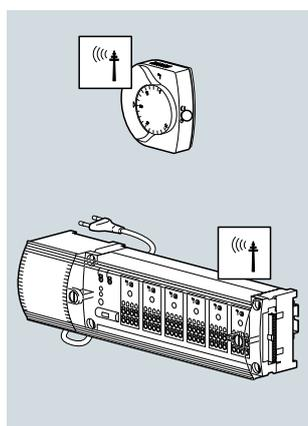
Клеммная колодка с передатчиком на 433 МГц передает радиосигналы от комнатного термостата к сервоприводу. К клеммной колодке 24 В (встроенный трансформатор) могут быть подключены до 6 термостатов и до 13 сервоприводов. Термостаты регулируют работу сервоприводов при помощи команд „Включить/выключить“. Расстояние между отправляющим и принимающим радиосигнал пунктами не должно превышать 25 м. При проблемах с передачей сигнала следует установить внешнее
