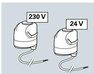
Термоэлектрический сервопривод profitherm® ( в обесточенном состоянии закрыт) предназначен для регулирования (открытие-закрытие) вентилей на коллекторе. Комнатный термостат (с напряжением 24 В/230 В или радио-термостат) управляет сервоприводом. Механизм устанавливается на вентиляющую вставку М 30 x 1,5 на коллекторе.
