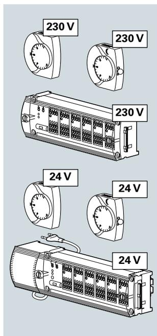
Клеммная колодка является блоком управления, соединяющим комнатный термостат с сервоприводом на коллекторе. Она полностью отвечает за энергоснабжение всех компонентов системы. Клеммная колодка обеспечивает рабочее напряжение 230 В (возможно исполнение с встроенным трансформатором 24 В) подключаемых к ней компонентов регулирующей системы: до 6 комнатных термостатов и до 13 сервоприводов. Термостаты регулируют работу сервоприводов при по-
