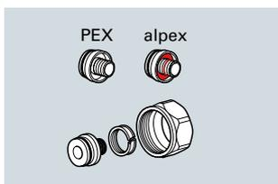
Компрессионное Разъемное соединение с евроконусом (3/4" - 18 углубление) для присоединения труб РЕ-Ха / PERT 14, 16 мм и alpex-duo XS / turatec-multi 16 мм к коллектору или радиатору.
