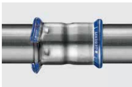
Цветные индикаторы пресс-соединения Marpress указывают на неопрессованные соединения еще до начала испытаний
