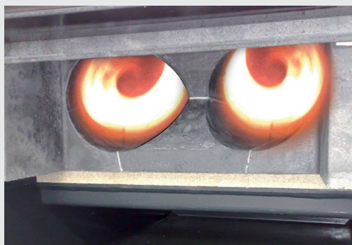
Высокая эффективность благодаря уникальной камере сгорания с двойным завихрем
