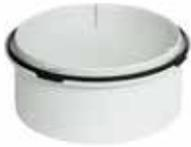
Соединительная муфта из полипропилена (PP) для соединения плоского коллектора profi-air с крышкой бетонной опалубки profi-air (принадлежности: комплект бетонной опалубки). С одной стороны муфта имеет байонетное соединение с резиновой уплотнительной манжетой, а с другой - отвод DN 160 с интегрированным стопором, не позволяющим вставить ревизионную пробку DN 160 слишком глубоко. Соединительная муфта подходит как для приточного, так и для вытяжного воздуха.
