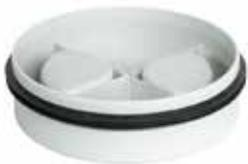
Ревизионная пробка из полипропилена (PP) для закупорки тройника profi-air DN 160 и соединительной муфты profi-air DN 160. Встроенное с одной стороны манжетное уплотнение герметично закупоривает соединение. Ревизионная пробка подходит как для приточного, так и для вытяжного воздуха.
